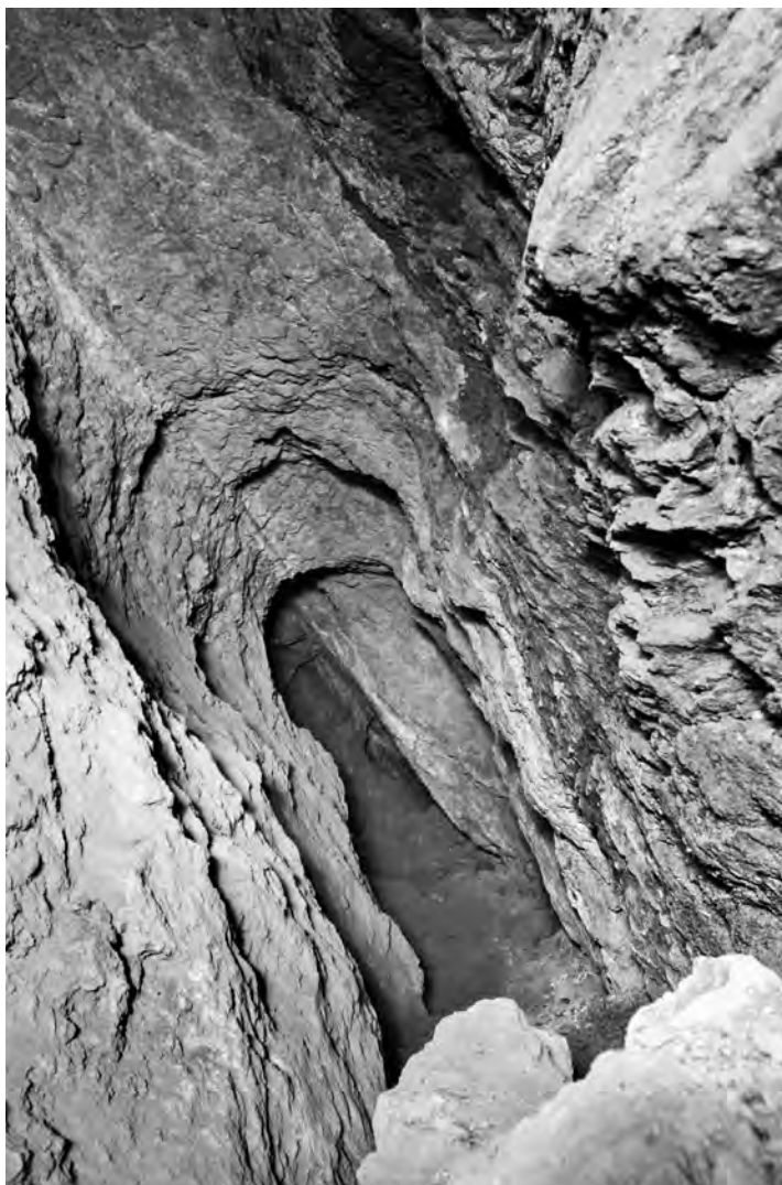
Fig. 6 Explotación vertical en la rafa principal de la mina de la Rambla del Abenque; puede observarse el filón en el techo, y la zona de contacto entre los mármoles nevado-filábrides y los esquistos alpujárrides.
