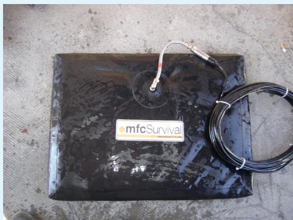
Coussin hydraulique et capteur de pression positionnés sous le caisson inox
