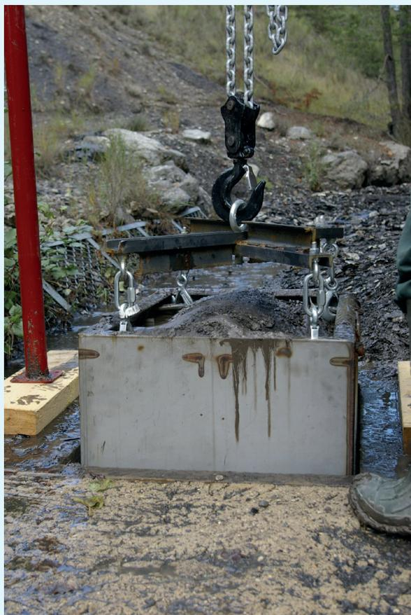
Zoom sur le dispositif d'accroche utilisé avec le treuil à chaîne pour l'extraction du caisson.
