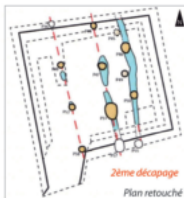
Fig. 25.2 : à -1,75 m plus bas (208,75 m ngf), apparition des fissures d'effondrement des galeries
