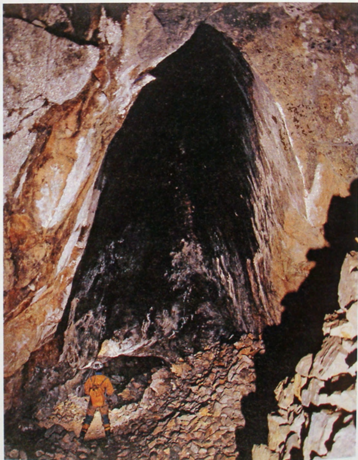
3. Dans la mine de Vallauria, le filon/couche de galène argentifère a été exploité par une succession de chambres spacieuses. Leurs voûtes en ogive, noircies par les fumées, présentent un développement exagéré qui implique que de grandes quantités de roches stériles ont été abattues inutilement (niveau Saraceni, Saint-Dalmas-de-Tende, Alpes-Maritimes)
